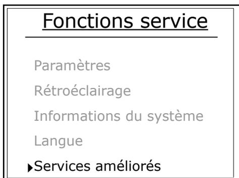
La fonction **Services améliorés (fig. 67)**, protégée par un mot de passe numérique sélectionnable à travers la poignée M, permet d'accéder aux fonctions d'essai réservées au personnel technique qualifié.
