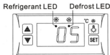
Es handelt sich dabei um eine kleine und integrierte intelligente Steuereinheit und ist für den Kompressor eines Hp einsetzbar. Die Hauptfunktionen umfassen: Anzeige, Temperaturregelung, manuelles/automatisches Abtauen durch das Ausschalten der Beleuchtungssteuerung, Abspeichern von Werten, Selbsttest, Sperrung der Parameter, Beleuchtungssteuerung.
