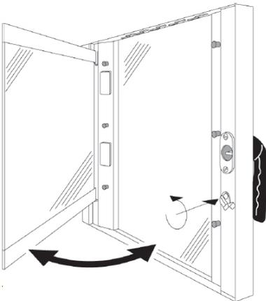
Le nettoyage de la vitre de la porte peut être effectué aussi bien de l'extérieur que de l'intérieur. Pour cela, il faut tourner le crochet qui retient la vitre interne, dans le sens des aiguilles d'une montre et, une fois ouverte, il faudra la nettoyer avec un détergent approprié.
