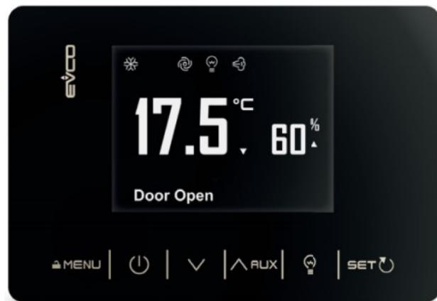
Für die Lagerung von Schokolade sollte die Umgebungstemperatur +12 / + 18 ° C sein und die Luftfeuchtigkeit unter 65 % liegen. Ändern Sie niemals die Luftfeuchtigkeit des Schranks. Für einen optimalen Betrieb des Schranks wurden die Innentemperatur- und Luftfeuchtigkeitseinstellung im Werk vorgenommen. Bitte nicht eingreifen.
