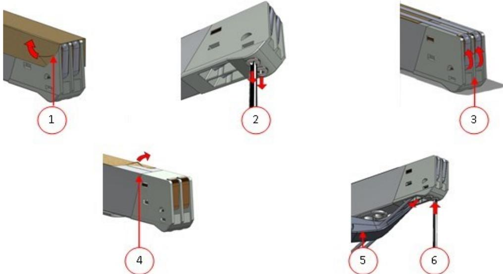
Abbildung 20: Austausch des Schweißdrahts
