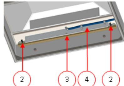
Abbildung 19: Entfernen der Schweißleiste (Metalldeckel)
