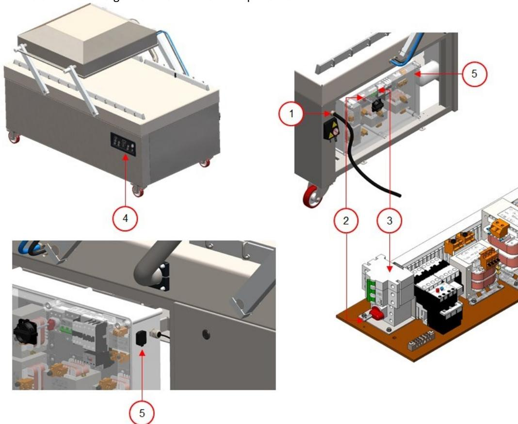
Abbildung 5: Übersicht über die Elektroinstallation
